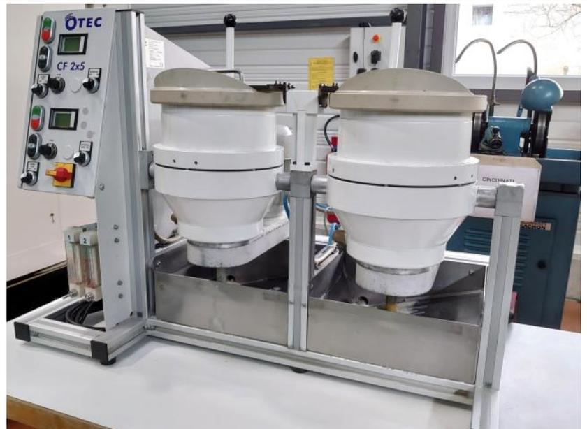
Machine à force centrifuge
