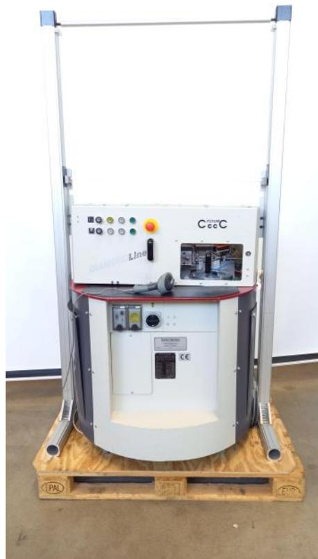
La machine FourC sert à mesurer automatiquement différentes formes de pierres qui ne sont pas détalonnées au cours de la rotation.
