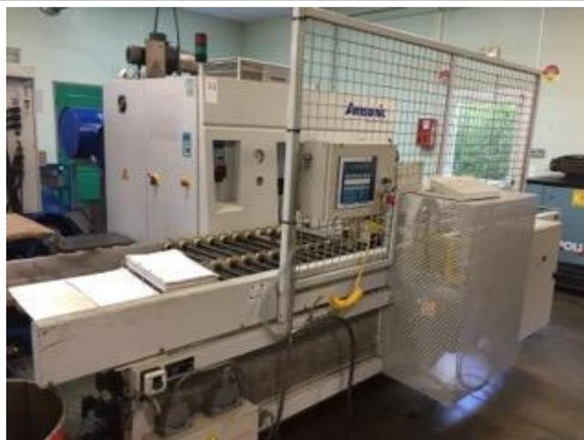
Machine de dégraissage automatique pour le lavage, le séchage.
