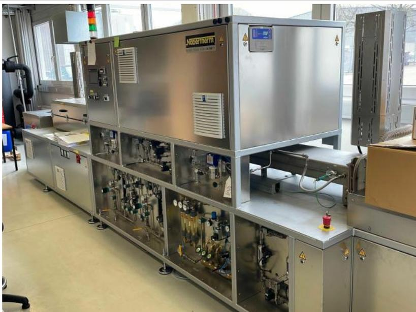
Four destiné au traitement thermique de pièces de précision dans une atmosphère à base d'hydrogène
